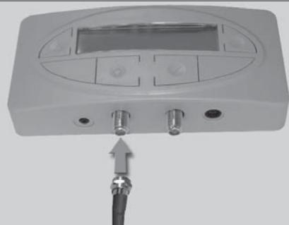
2. Anschluss Satfinder – Receiver / connection Satfinder – receiver / connexion Satfinder – récepteur
